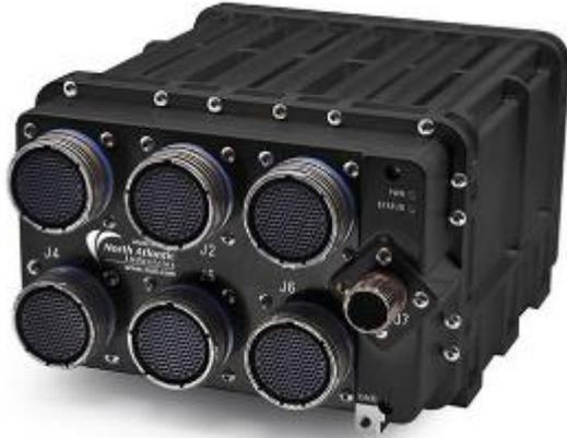
North Atlantic Industries 社より、70 種類を超えるモジュールから最大 18 個のモジュールを搭載することが出来る、OpenVPX で実機搭載用堅牢型 COTS システムである **SIU36** が発売されました。
